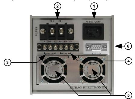
1)AC inlet (IEC C14 type 3pins)
