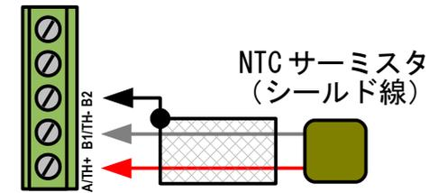
※配線が長い場合は3導線式シールド線接続を推奨します。
