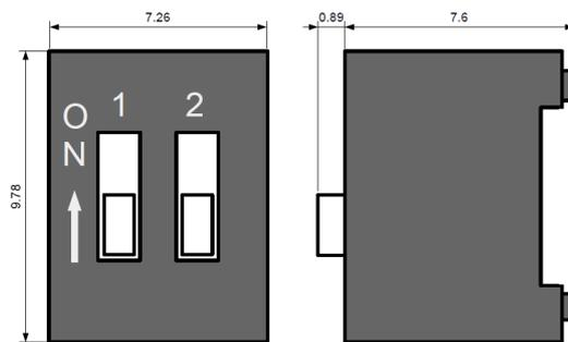
②ロッカースイッチタイプ（Grayhill 76SB02T）※上側を押すとON、下側を押すとOFF
